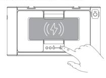
有线充电: 兔笼开机后,使用 USB-A 充电线连接 USB-A 接口即可进行有线充电。
